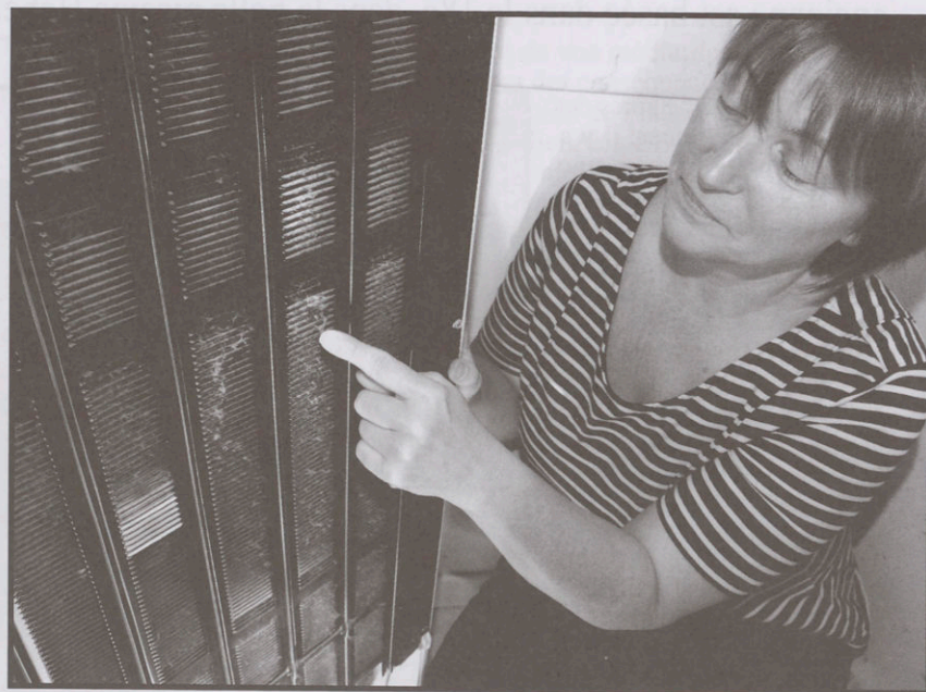
Pour économiser l'énergie, pensez également à nettoyer l'arrière du frigo.
