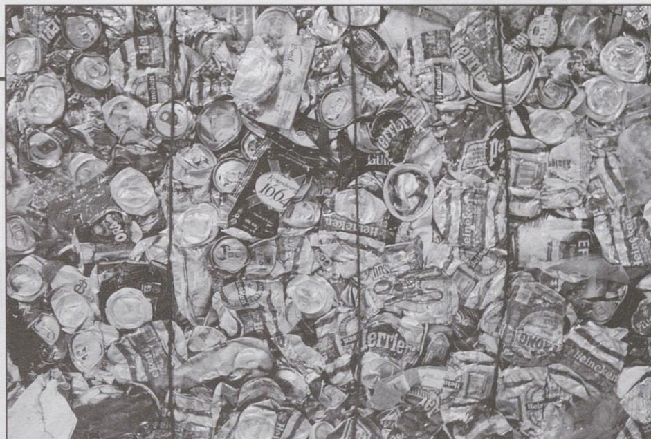
Les canettes en aluminium, séparées des boîtes de conserves en fer par des aimants, sont ensuite compressées avant de partir pour être fondues.
